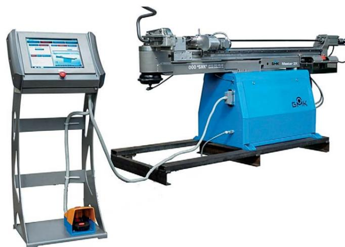
Станок предназначен для холодной высокоточной, 3-координатной, дорновой и бездорновой гибки:
