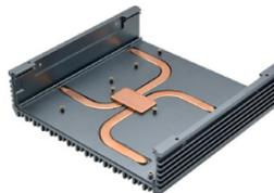
**Пассивная система охлаждения**
