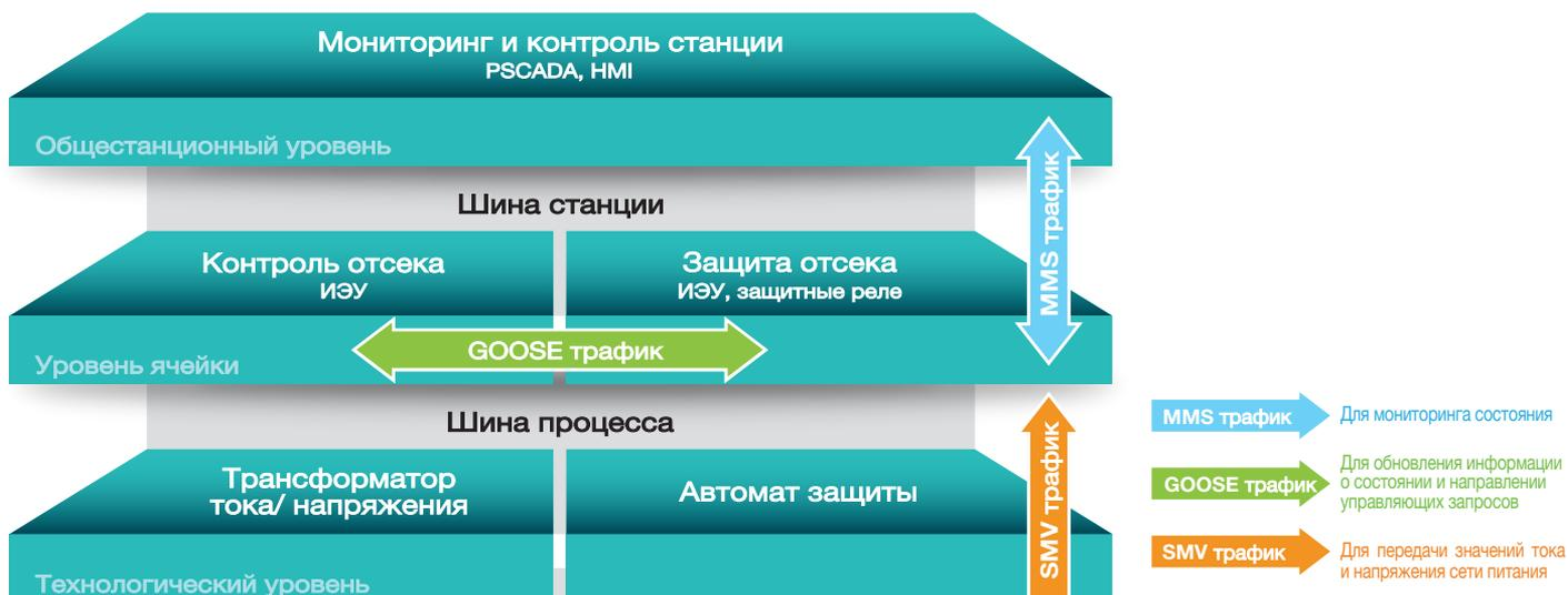
Пример на приведенном ниже рисунке демонстрирует, как три данных протокола влияют на обмен данными между подстанциями.
