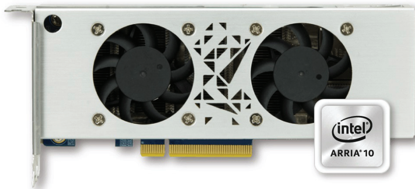
Рис. 1. Плата Mustang-F100 от IEE Integration
