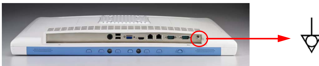
Figure 2.8 POC-W212 Equipotential Terminal Pin
