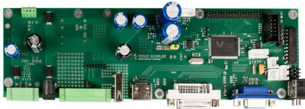
Серия мониторов SDA оснащена платой видеоконтроллера, которая была полностью разработана компанией “Ниеншанц-Автоматика”. Базовое напряжение питания составляет 24В постоянного тока, а подключить видеосигнал можно по интерфейсам VGA, DVI-D или HDMI. Наряду со стандартными функциями, плата может быть оснащена, ИК датчиком для работы с пультом ДУ, и двухканальным звуковым усилителем с динамиками.
