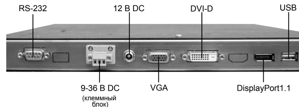
В первую очередь подключите и зафиксируйте все необходимые интерфейсные кабели (VGA, DVI, DP, USB, RS-232). Затем подключите обесточенный кабель питания. Монитор имеет два входа питания: трехконтактный клеммный блок для подключения к бортовой сети с постоянным напряжением 9-36 В и круглый разъем для подключения адаптера питания с выходным напряжением 12 В (идет в комплекте).
