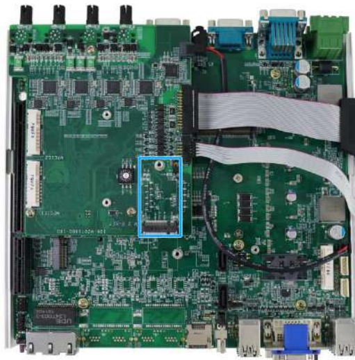
M.2 slot on MeziO™ module
