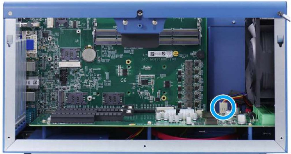
Remove 4-pin fan connector
