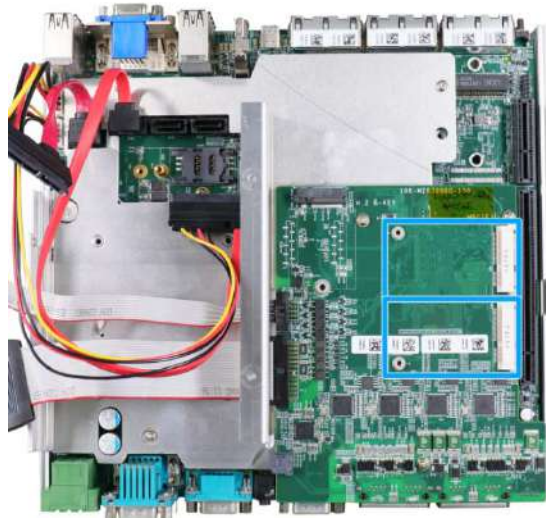
mini-PCIe slot on MeziO™ module
